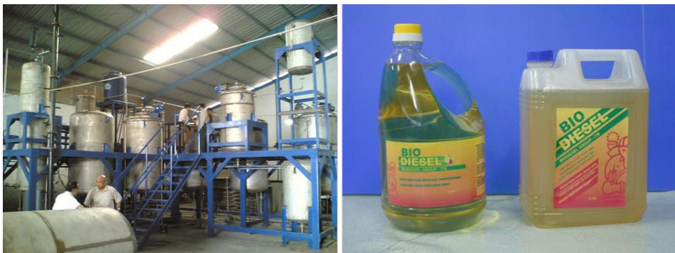
Gambar 11 Unit Produksi ITB Kapasitas max 5 ton/hari (kiri) dan Produk Biodiesel yang Dihasilkan ITB (kanan) (Sumber: Dokumentasi Koleksi Tirto Prakoso)
