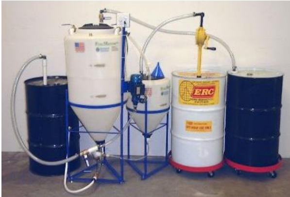
Gambar 15 PT Rekayasa Industri mendesain Biodiesel dari minyak jarak yang dapat dibuat di rumah ( home industry ) atas permintaan Kementerian Perindustrian (Sumber: Dokumentasi Koleksi Tirto Prakoso)
