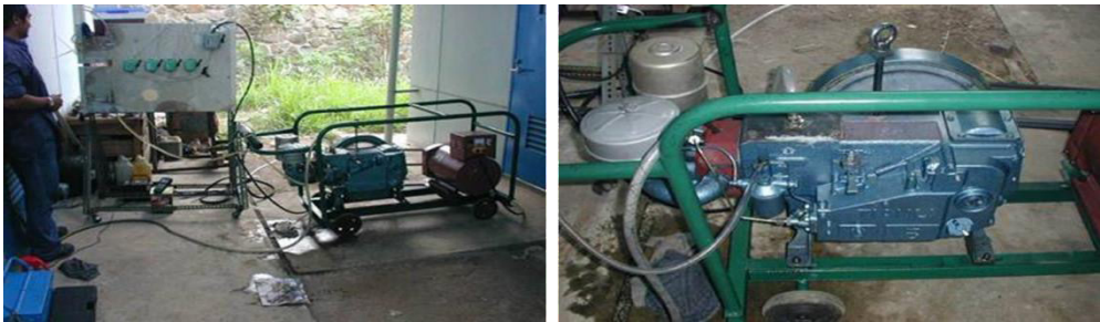
Gambar 10 ITB Melakukan Uji Coba Biodiesel Pada Generator Murah Produk Dong Feng 5 kW. (Sumber: Dokumentasi Koleksi Tirto Prakoso)
