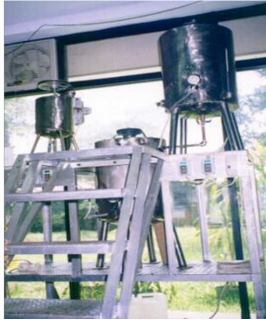
Gambar 21 Riset dan Lab Scale biodiesel 25 liter/ batch (Sumber: Dokumentasi Koleksi Tirto Prakoso)
