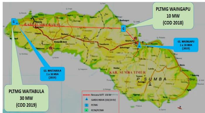
**Gambar 4.20 Rencana Pengembangan Pembangkit, Gardu Induk dan Transmisi Sistem Sumba**
