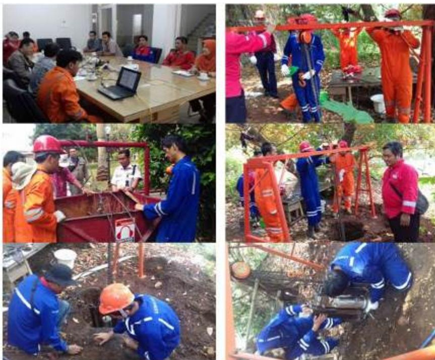
**Gambar 3.56 Uji coba Airgun di Halaman Lemigas dengan Tekanan Maksimal 650 Psi**
