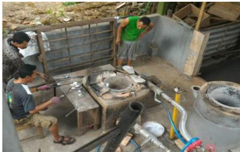
**Gambar 3.51** Gasmin yang Dipasang di IKM/UMKM Peleburan Aluminium
