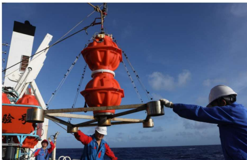
Gambar 21. OBS yang digunakan untuk merekam data
