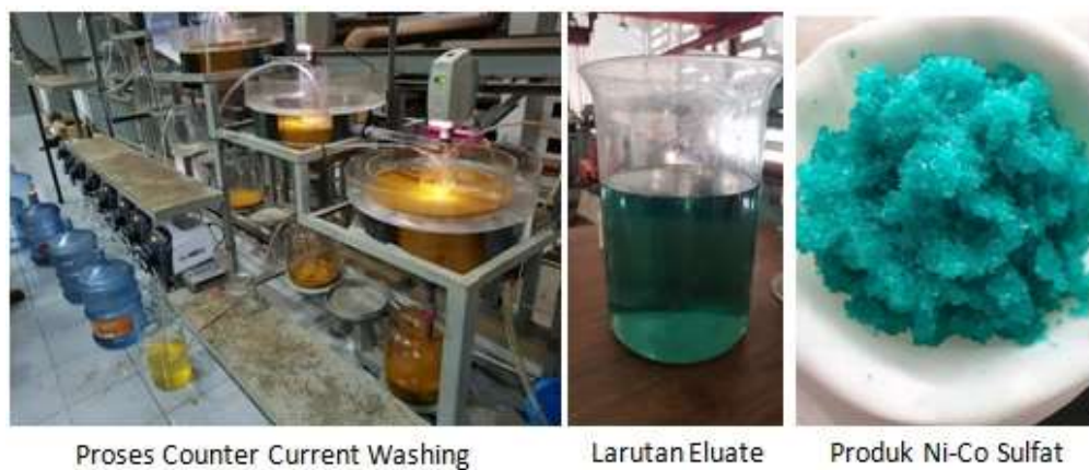
Gambar 12. Proses Ekstraksi Biji Nikel menjadi Nikel Sulfat
