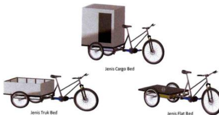
Gambar 27. Rancangan Sepeda Listrik 3 Roda
