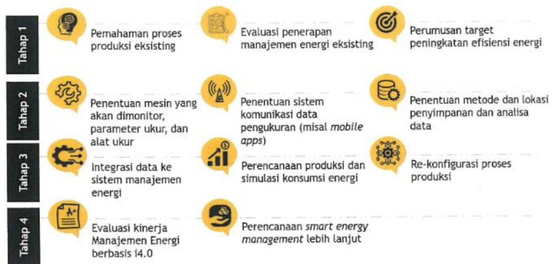
Gambar 26. Tahapan Integrasi Manajemen Energi i4.0
