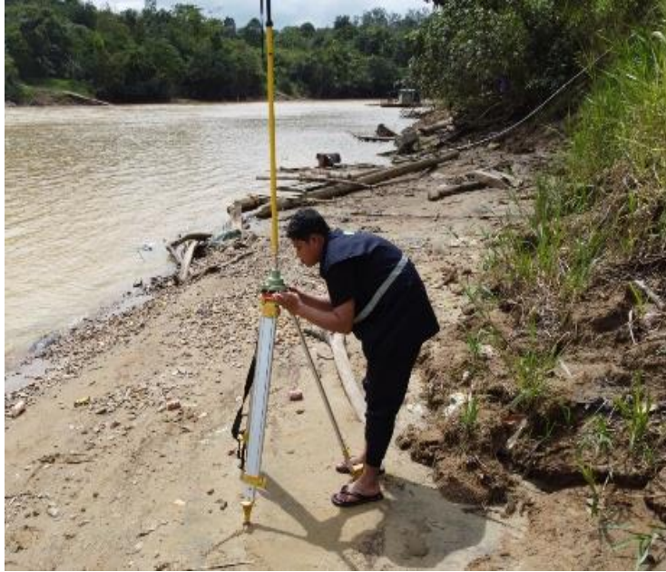
Gambar 3. 8. Pengukuran Topografi Menggunakan GPS Geodetic
