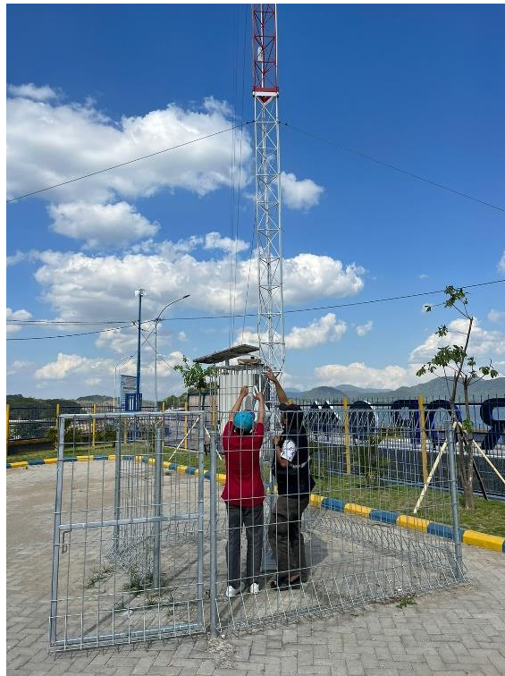
Gambar 3. 6. Pemasangan Alat Ukur Surya Pyranometer di Bendungan Batu Bulan, Sumbawa, Nusa Tenggara Barat
