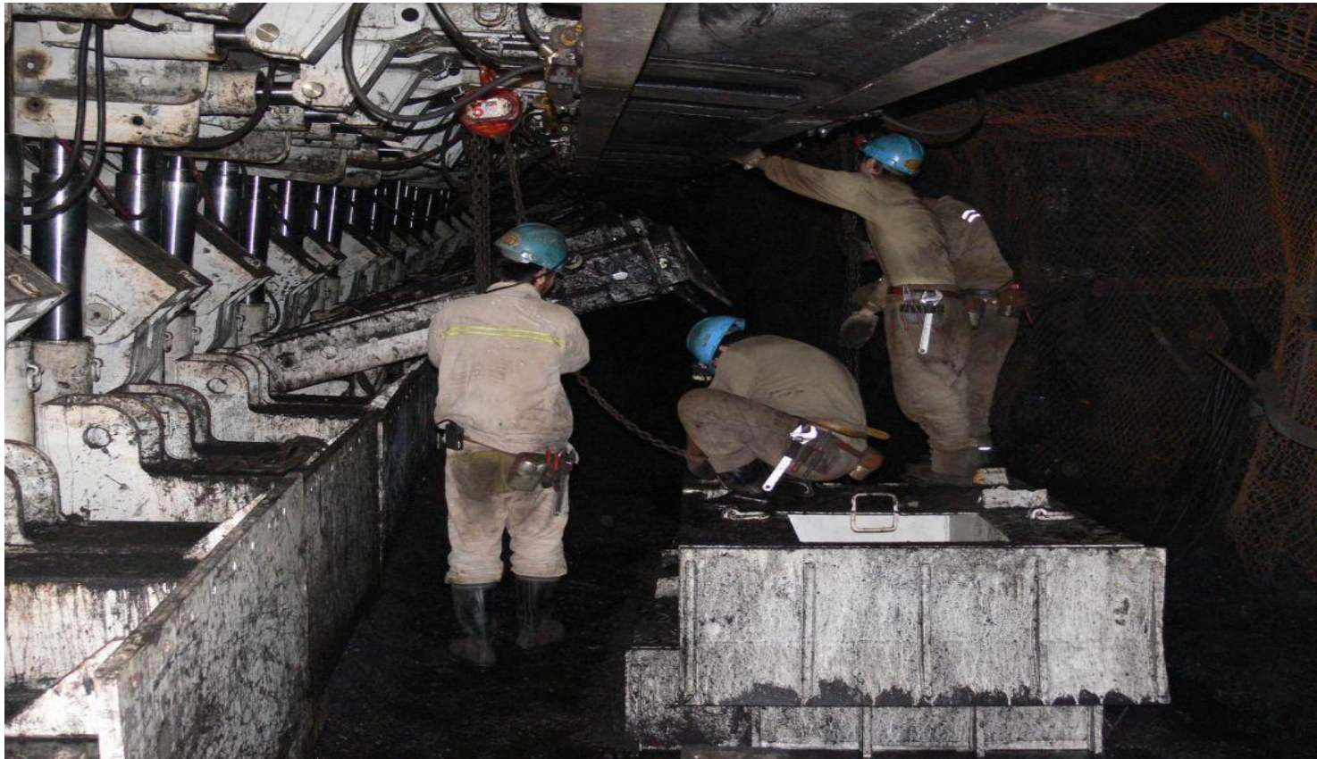
山东能源新汶矿业集团综合机械化充填开采
